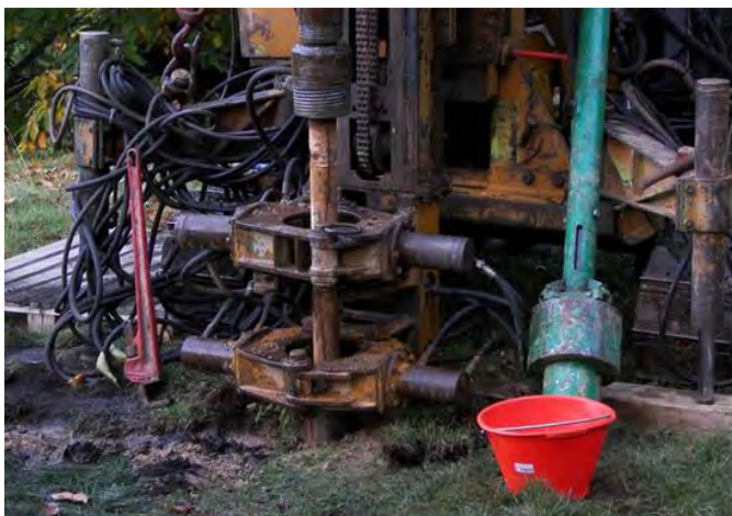
Figura 76: Macchina operatrice per la realizzazione di micropali tubfix. A sinistra sistema di scavo a rotopercussione, a destra sistema di scavo mediante trivella elicoidale.
