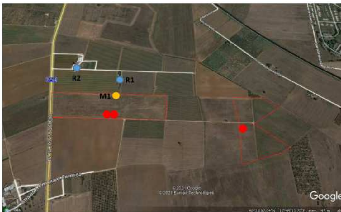
AREA LP_1: Indicazione dei ricettori (pallini azzurri), delle cabine inverter / trasformazione BT/MT (pallini rossi), dei punti di misurazione di Leq(A) (pallini gialli)
