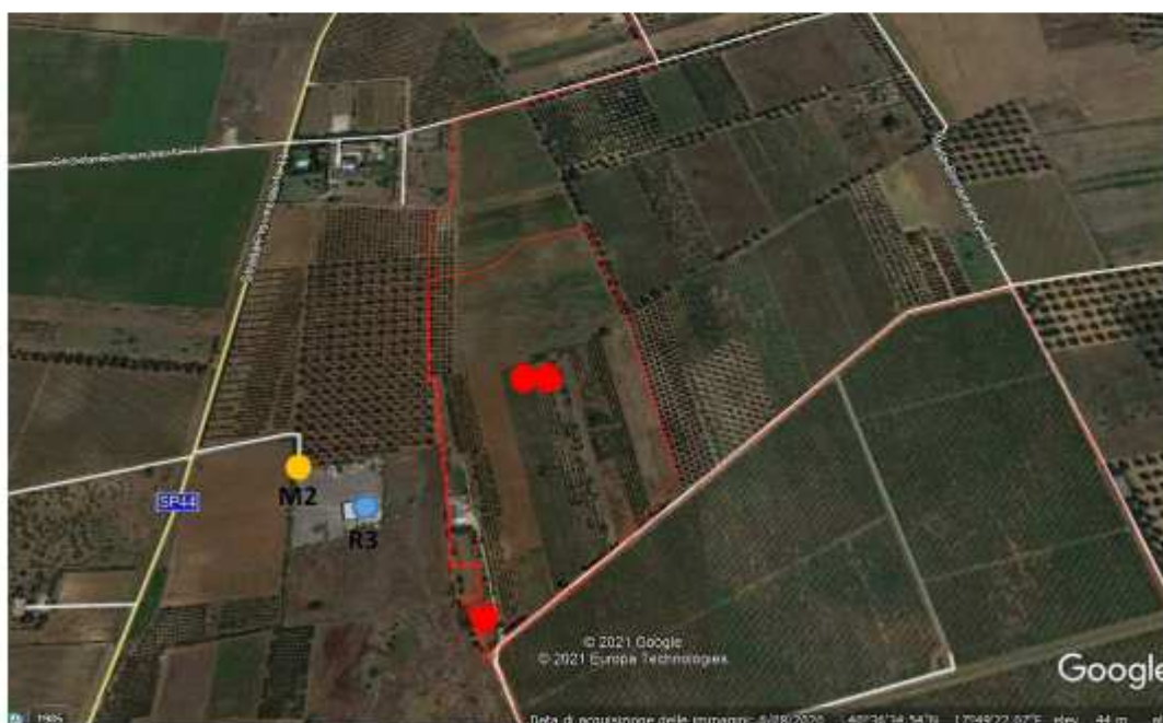
AREA LP_2: Indicazione dei ricettori (pallini azzurri), delle cabine inverter / trasformazione BT/MT (pallini rossi), dei punti di misurazione di Leq(A) (pallini gialli)
