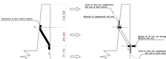
Particolare sistema connessione Cabina / Vasca (Scala 1:10)
