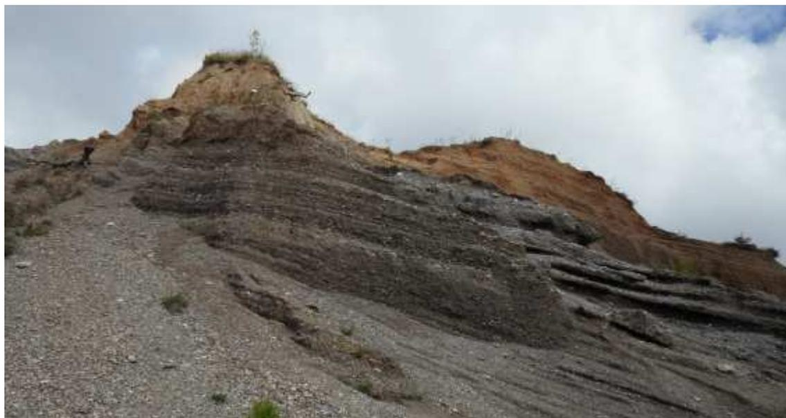
FOTO 2 – Piazzale con evidente formazione di eccessivi angoli di riposo del materiale cavato.
