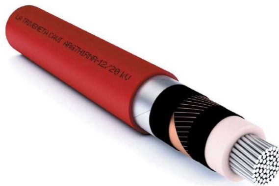
Fig. 12: Cavo isolato, schermato in Cu ed armato con nastro in Al, da interrare per trasmissione di maggiori potenze
