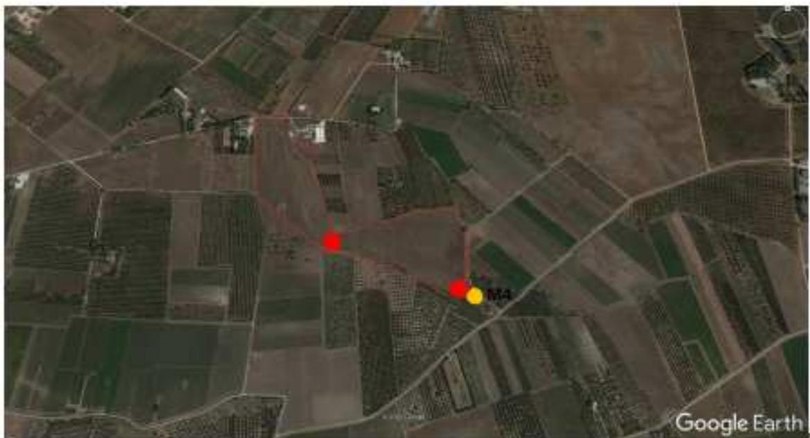
Indicazione dei ricettori (pallini azzurri), delle cabine inverter / trasformazione BT/MT (pallini rossi), dei punti di misurazione di Leq(A) (pallini gialli)
