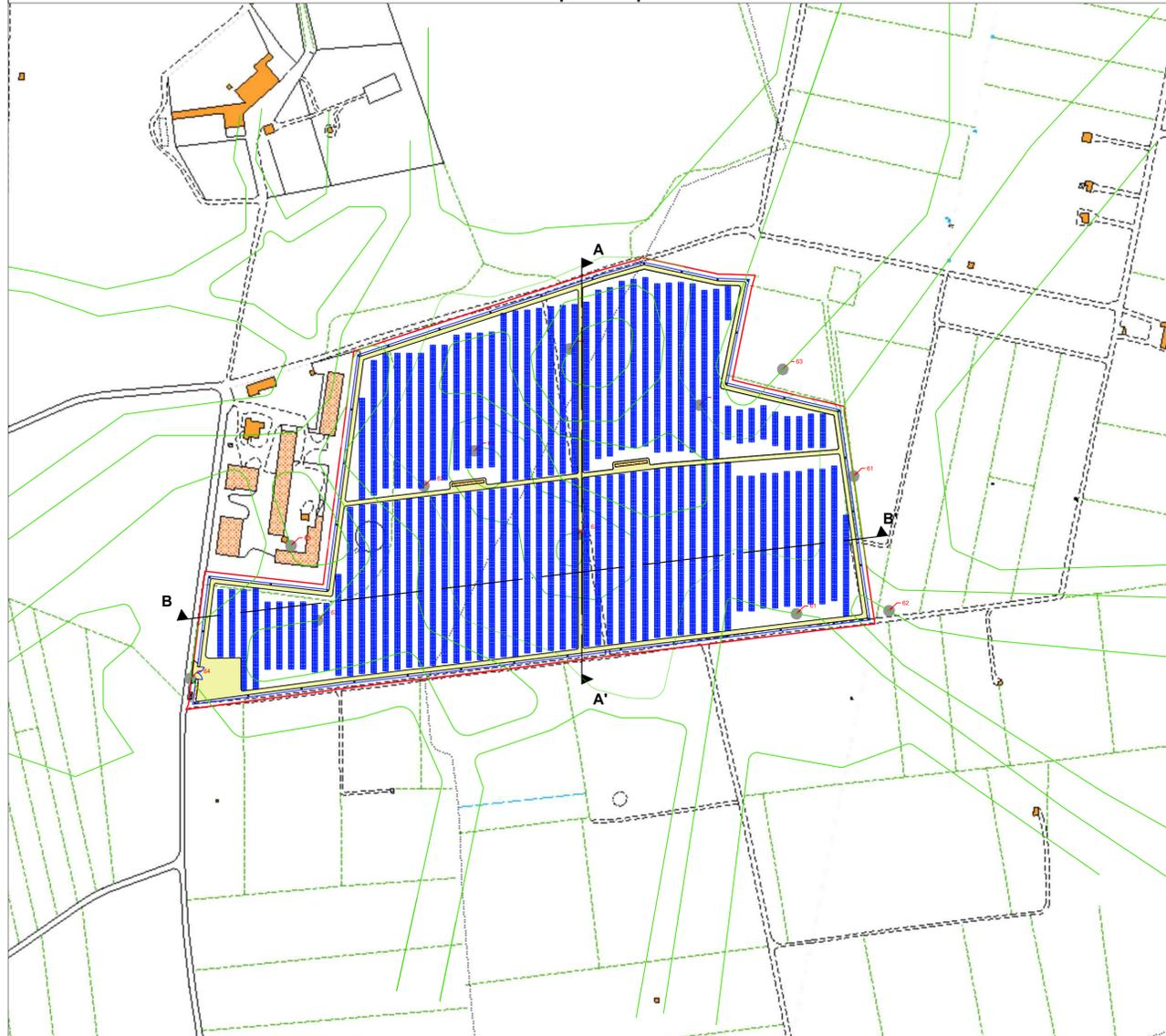
Non è prevista alcuna movimentazione del terreno per la realizzazione delle opere in progetto. La tipologia di impianto non reca modifiche a livello geomorfologico, essendo le strutture di sostegno dei moduli di tipo vibroinfisso nel terreno. Tali strutture non richiedono scavi per l'installazione, tantomeno la creazione di zattere di fondazione in cemento. Vedasi la Relazione "Terre e Rocce da scavo" (C9DVVB4\_DocumentazioneSpecialistica\_12\_Rev3)
