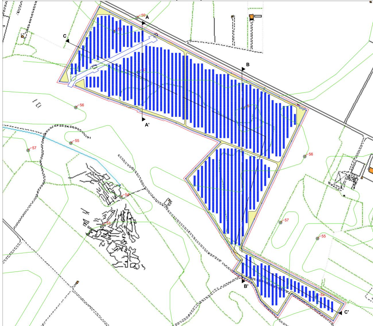
Non è prevista alcuna movimentazione del terreno per la realizzazione delle opere in progetto. La tipologia di impianto non reca modifiche a livello geomorfologico, essendo le strutture di sostegno dei moduli di tipo vibroinfisso nel terreno. Tali strutture non richiedono scavi per l'installazione, tantomeno la creazione di zattere di fondazione in cemento. Vedasi la Relazione "Terre e Rocce da scavo" (C9DVVB4\_DocumentazioneSpecialistica\_12\_Rev3)
