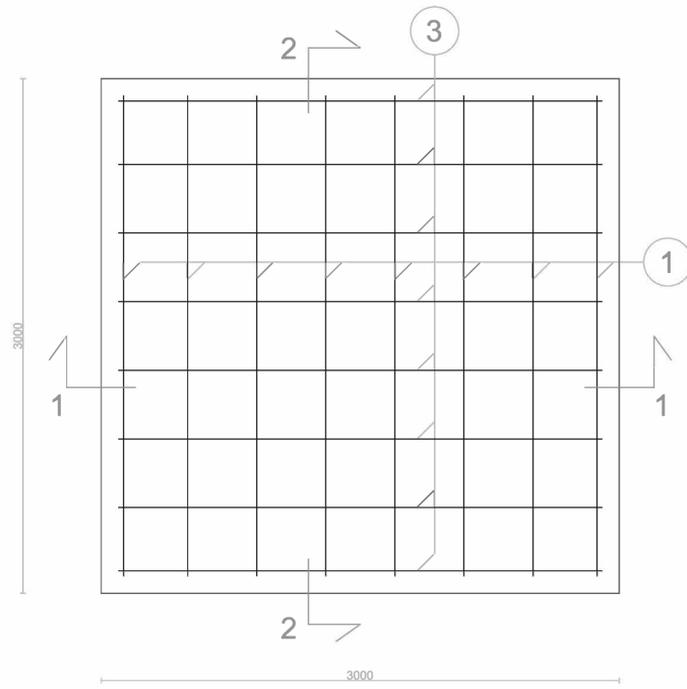
Pianta armatura superiore
