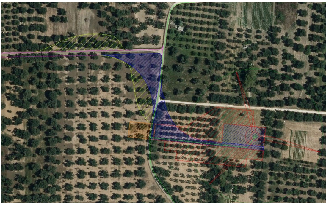
Fig.14 - Espianti ulivi area strada ingressoWTG MES07 Strada comunale da adeguare
