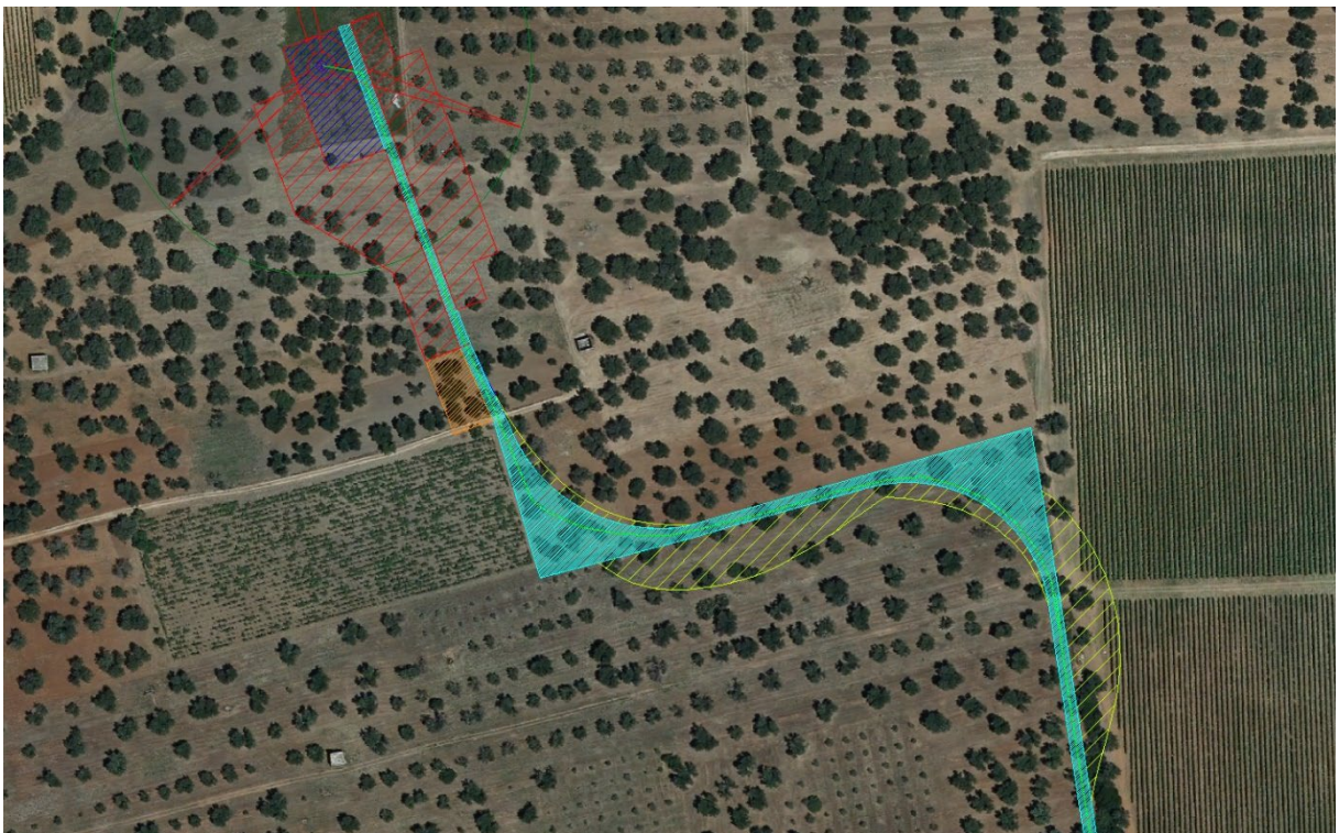
Fig.11- Espianti ulivi area strada ingressoWTG MES04 Gli ulivi saranno reimpiantati nell'ambito della stessa area
