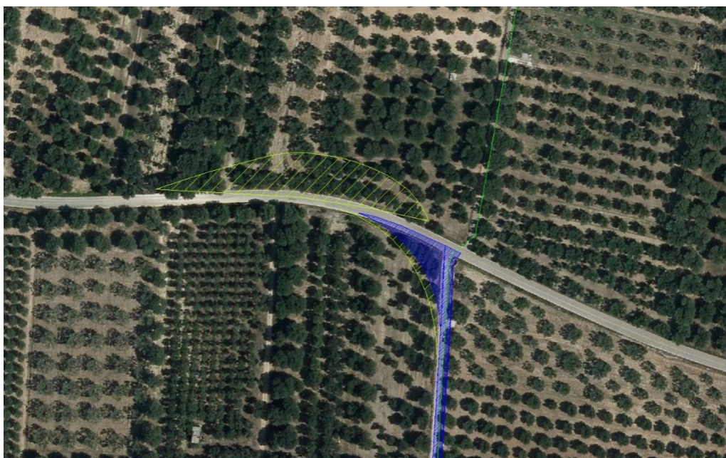
Fig.3 - Espianti ulivi per accesso alla WTG MES05 da Sp51– Gli ulivi saranno reimpiantati nell'ambito della stessa area
