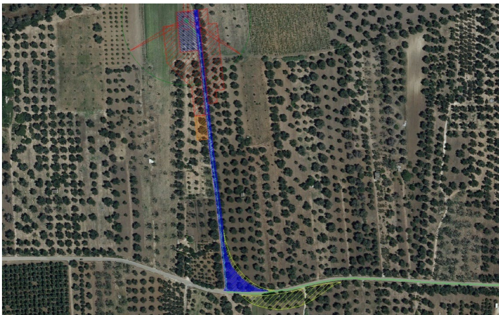
Fig.6 Espianti di alberature di ulivo accesso alla WTG MES02 dalla SP73. Gli ulivi saranno reimpiantati nell'ambito della stessa area
