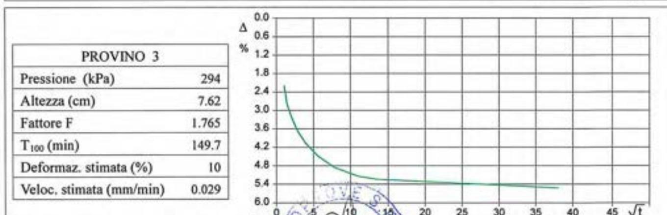
Velocità stimata di prova =  $(H \cdot DefV) / (100 \cdot F \cdot T_{100})$  - Velocità media di prova (mm/min) = 0.030
