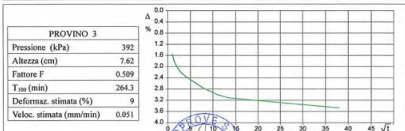
Velocità stimata di prova =  $(H \cdot DefV) / (100 \cdot F \cdot T_{100})$  - Velocità media di prova (mm/min): 0.045
