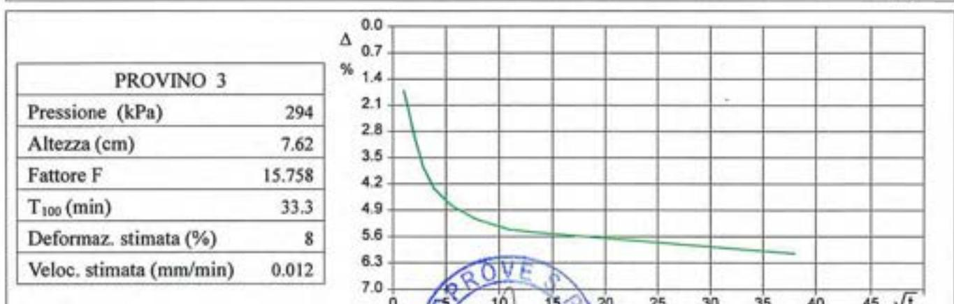
Velocità stimata di prova =  $(H \cdot DefV) / (100 \cdot F \cdot T_{100})$  Velocità media di prova (mm/min): 0.004
