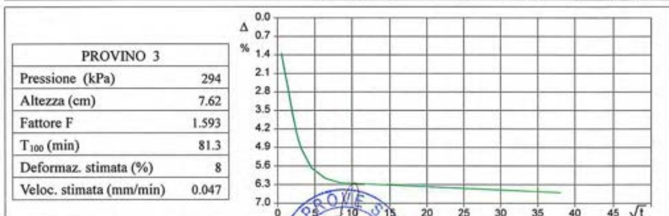
Velocità stimata di prova =  $(H \cdot DefV) / (100 \cdot F \cdot T_{100})$  Velocità media di prova (mm/min): 0.050
