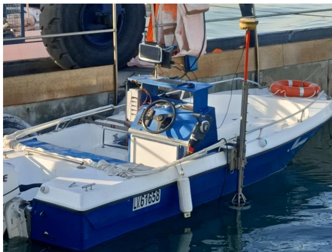
Fig. 2 – Imbarcazione equipaggiata con strumentazione ADCP
