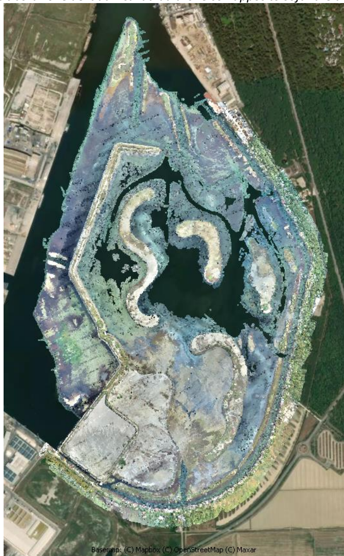
Fig. 10 – Nuvola di punti complessiva, successivamente pulita dai punti errati e da tutte le parti rilevate con la batimetria.
