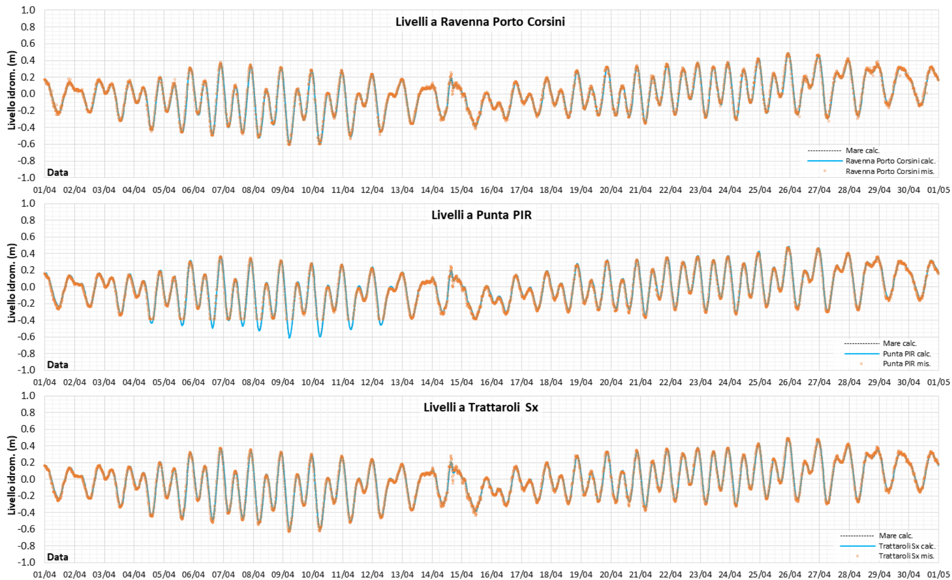
Figura 4.4 – Confronto tra livelli idrici calcolati e misurati nel mese di Aprile 2020 a Ravenna Porto Corsini, Punta PIR e Trattaroli Sx.
