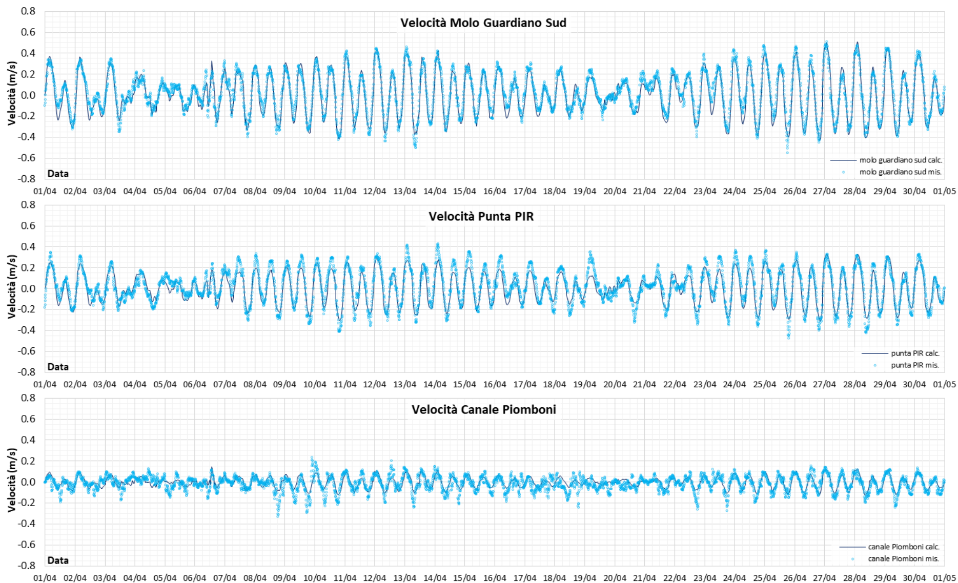
Figura 4.7 – Confronto tra velocità calcolate e misurate nel mese di Aprile 2021 a Molo Guardiano Sud, Punta PIR e Canale Piomboni.
