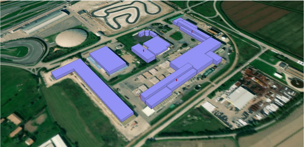
Figura 4 - Ricostruzione tridimensionale dei volumi considerati nella schematizzazione del building downwash (vista da SE)
