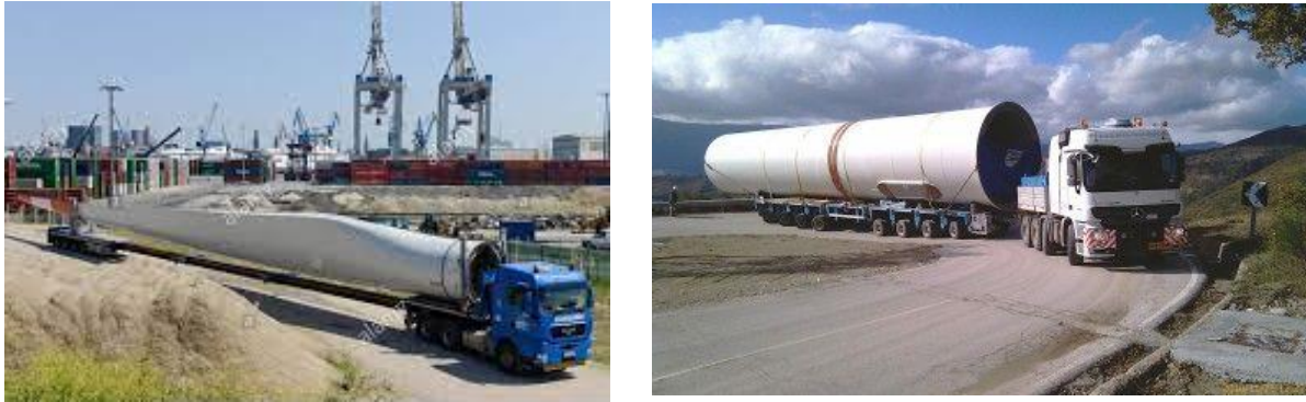
Figura 34 Trasporto elementi di torre e pala eolica
