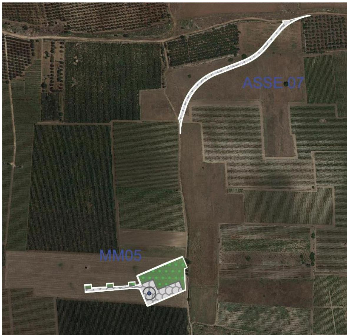
**Asse 08 AD:** A seguire l'Asse 07, il tragitto prevede di reimmettersi su viabilità esistente per cui necessita prevederne l'adeguamento fino all'ingresso in piazzola dell'aerogeneratore MM05.
