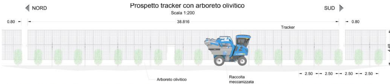
Figura 2. Illustrazione di progetto. Prospetto dell'impianto agrivoltaico con una fila di tracker in posizione verticale sullo sfondo e una fila di olivi allevati a siepe. Il disegno è completo di distanze e misure degli elementi, inoltre è illustrata in scala la macchina scavallatrice per la raccolta meccanizzata delle olive in continuo.
