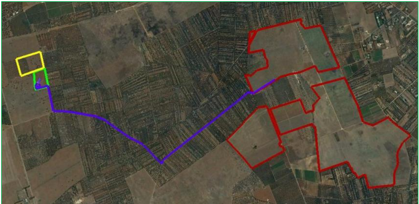
Figura 4 - Cavidotto MT da impianto ad SU - SE Terna
