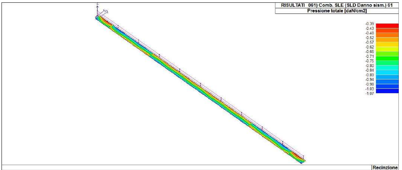
46_RIS_PRESSIONI_061_Comb. SLE (SLD Danno sism.) 61
