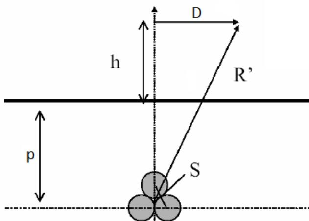
Tenendo conto dei limiti di legge sopradescritto di  $3 \mu T$ , da simulazione eseguita mediante software si ricavano le DPA relative alle linee riportate di seguito in funzione della distanza  $D[m]$  (distanza orizzontale del punto in analisi rispetto all'origine del Sistema di riferimento).
