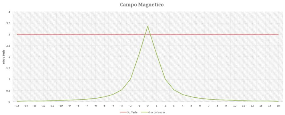
Caso 2: linea MT V=36kV in cavo armato 2x(1x(1x630))mm<sup>2</sup> interrato con posa a trifoglio, corrente I=496,5 A per terna di cavi, S=0.415.
