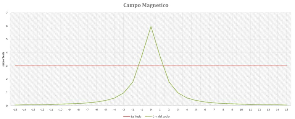
Caso 3: linea MT V=36kV in cavo armato 4x(3x(1x400))mm<sup>2</sup> interrato con posa a trifoglio, corrente I=331,5 A, S=0.0451m.
