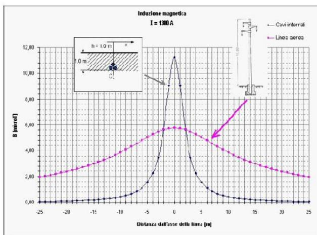
Figura 1: Attenuazione dell'induzione magnetica dovuta all'interrimento dei cavi
