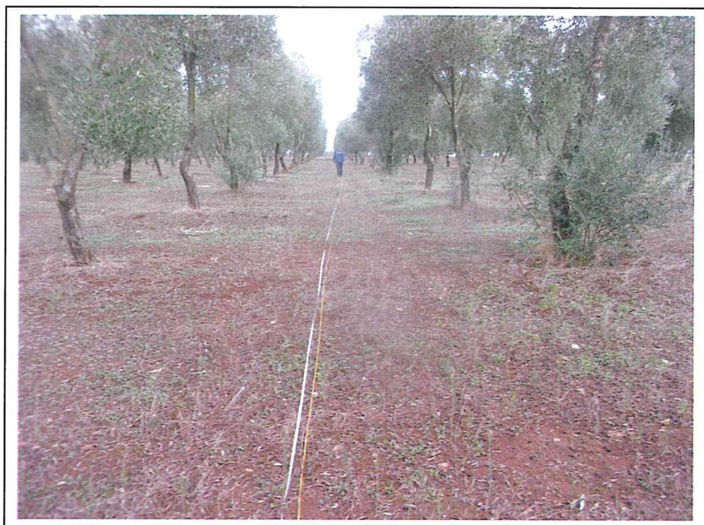
Esecuzione profilo sismico a rifrazione n. 4
