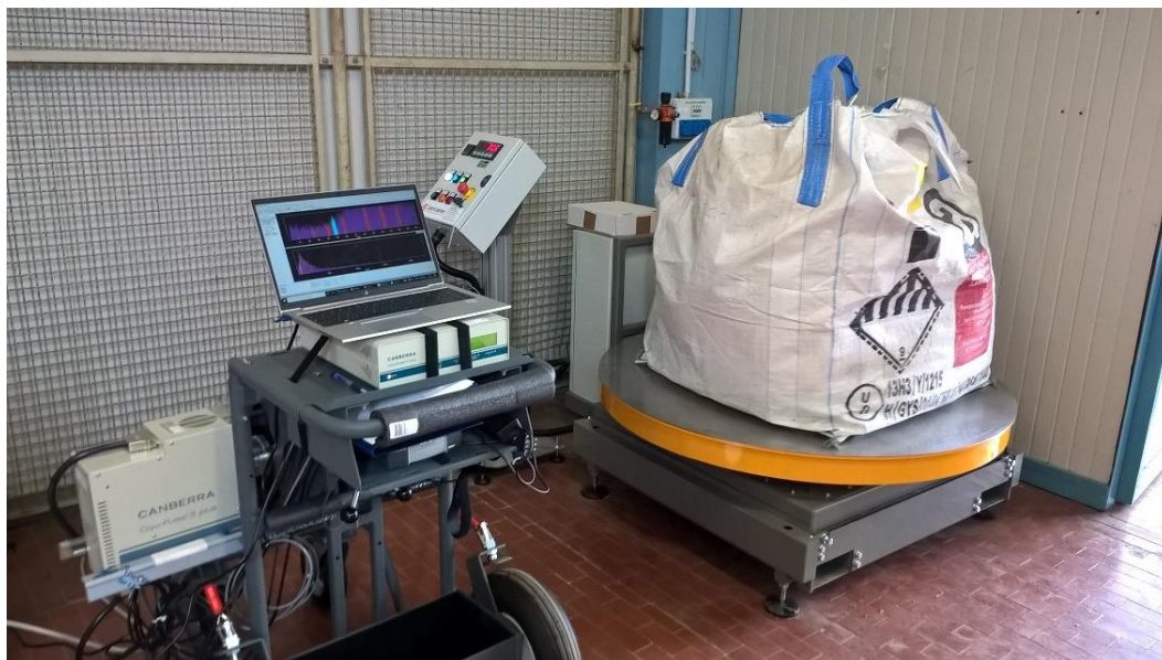
Figura 6–14 Stazione ISOCS e tavola rotante
