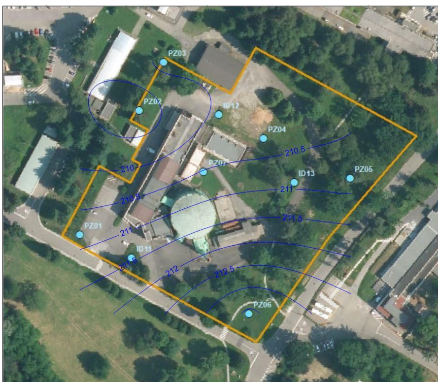
Figura 7–9 Andamento della superficie piezometrica in sito a dicembre 2021
