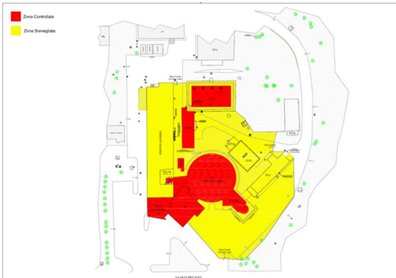
Figura 4-16 – Classificazione delle aree dell’impianto Ispra1
