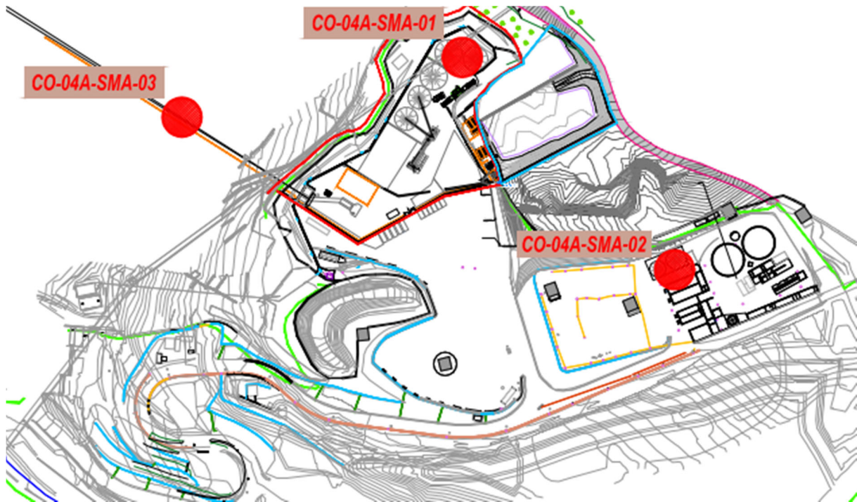
Figura 15: Punti di monitoraggio relativi alla componente "terre e rocce da scavo"
