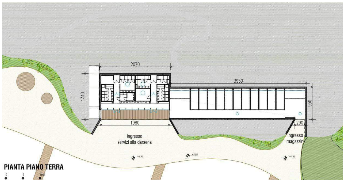
Figura 3-19: Localizzazione e pianta dell'edificio B
