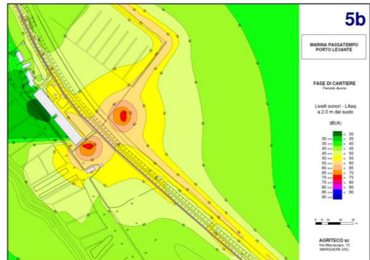
Figura 5-3 – Elaborazione modellistica previsionale del rumore – Fase di cantiere (due macchine)
