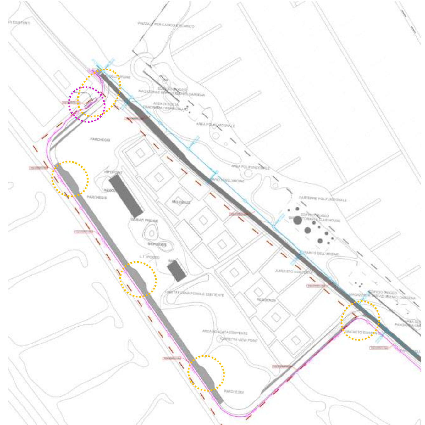
Figura 3-31: Configurazione rete elettrica e nuova viabilità interna - Progetto 2020 – cerchiato modifiche alla rete elettrica ed strada
