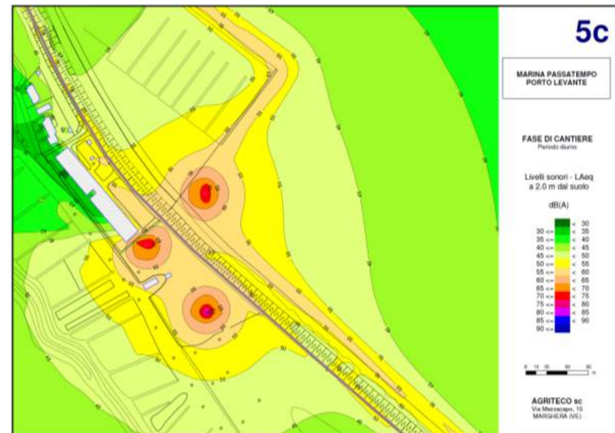
Figura 5-4 – Elaborazione modellistica previsionale del rumore – Fase di cantiere (tre macchine)
