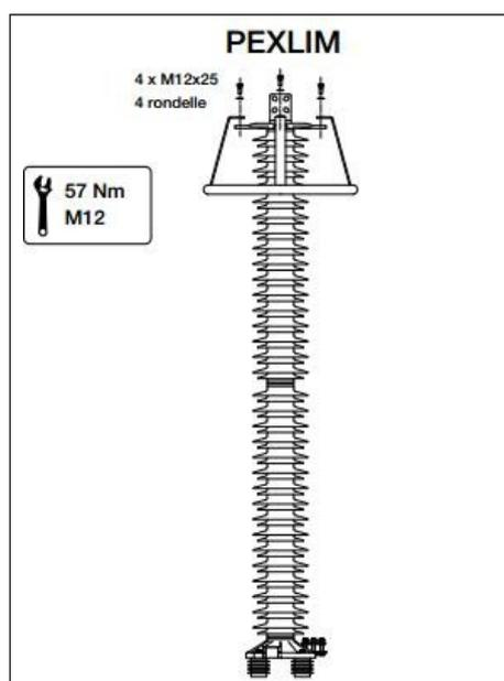
*Fig. 12. Particolare di dettaglio dello scaricatore AT.*
