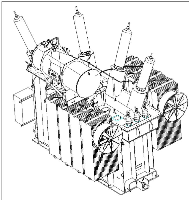
*Fig. 18. Vista assometrica del trasformatore di progetto*
