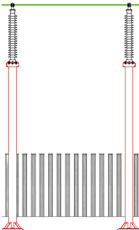
*Fig. 16. Particolare prospettico dei supporti rompitratta unipolari*
