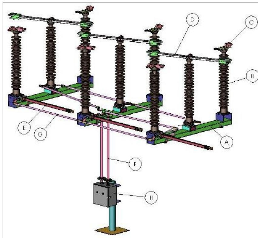
*Fig. 13. Parti principali che compongono un sezionatore.*
