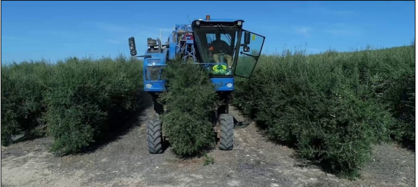
Raccolta meccanizzata con macchina scavallatrice
