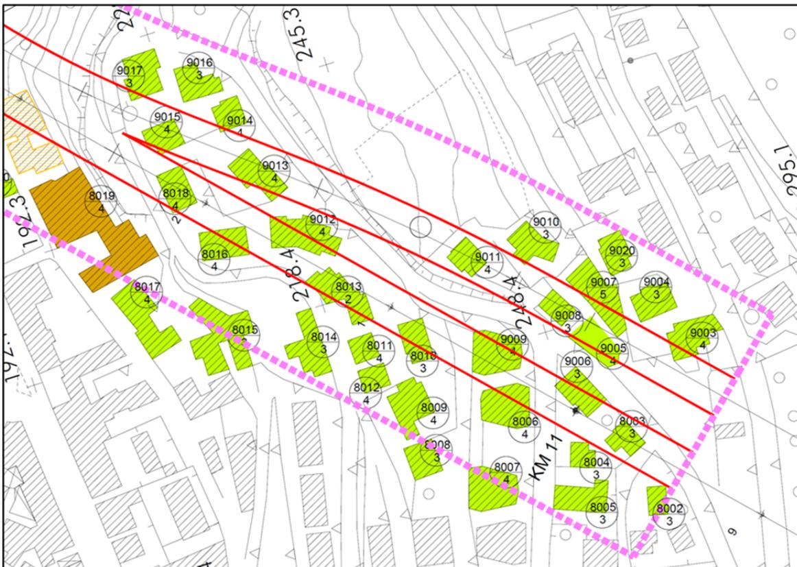
Figura 27 Bivio Trento Nord, imbocco galleria – Fascia di potenziale disturbo da vibrazioni ferroviarie nella condizione di singolo transito di un treno merci – Focus su tratta in galleria naturale a doppia canna
