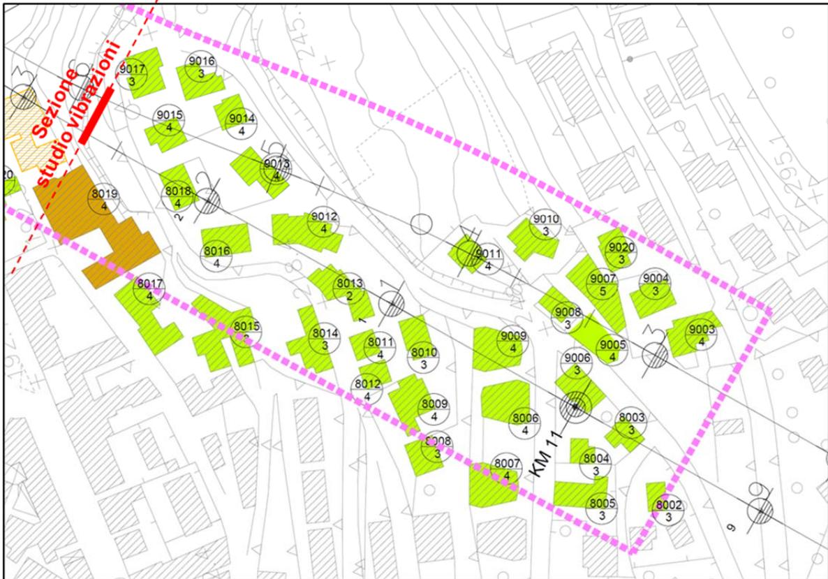
Figura 18 Bivio Trento Nord – imbocco galleria, individuazione della sezione critica per le vibrazioni
