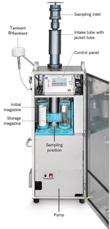
Figura 4-1 Campionatore sequenziale automatico
