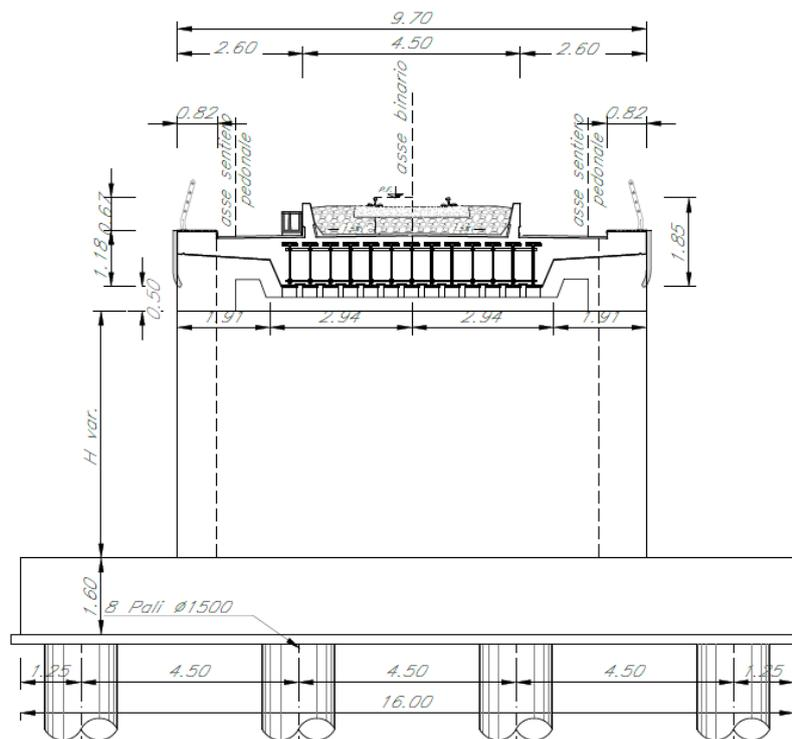
Figura 2 – Sezione trasversale spalla H=4.50 m
