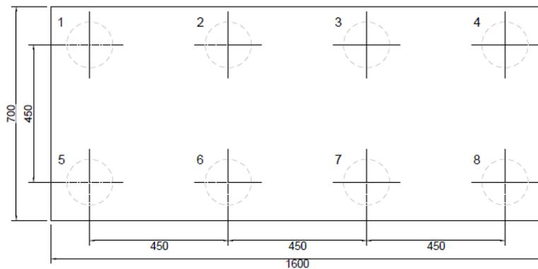
*Figura 3 – Disposizione dei pali di fondazione*
