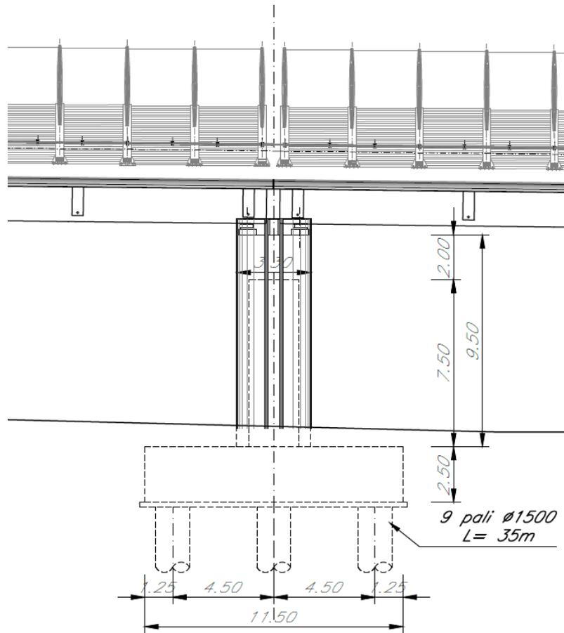
Figura 1 – Prospetto longitudinale pila
