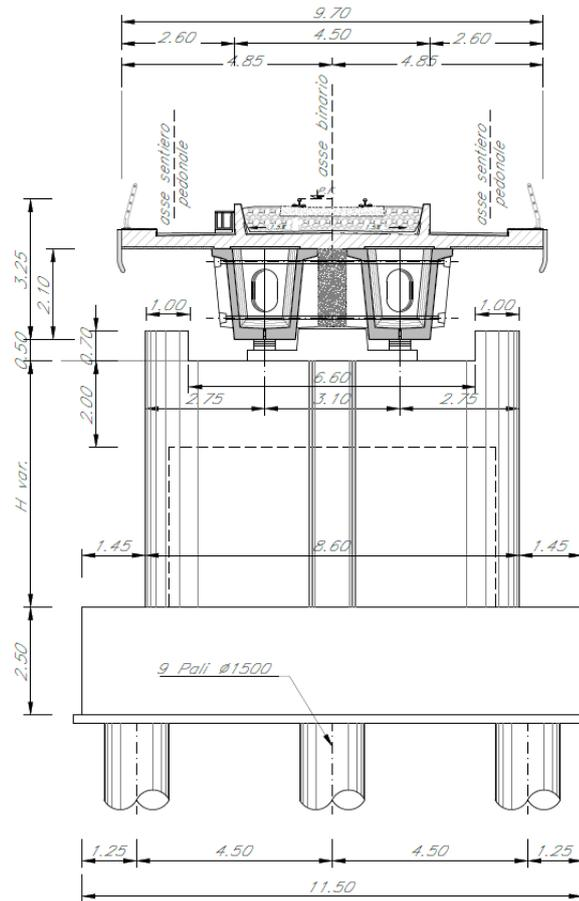
Figura 2 – Sezione trasversale pila H=9.50 m
