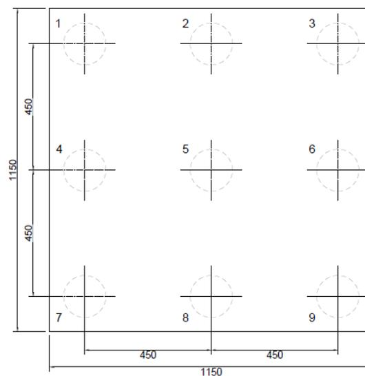
Figura 3 – Disposizione dei pali di fondazione
