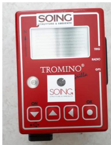
Figura 2.2.2.1: Tromografo per la misura microtremori - TROMINO©Engi
