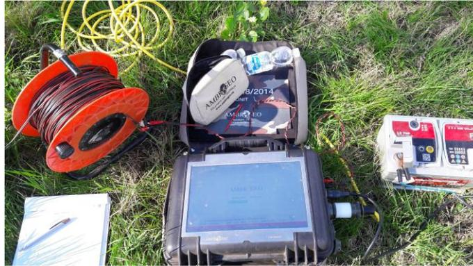
Figura 2.1.2.1: Sismografo digitale a 24 bit..
