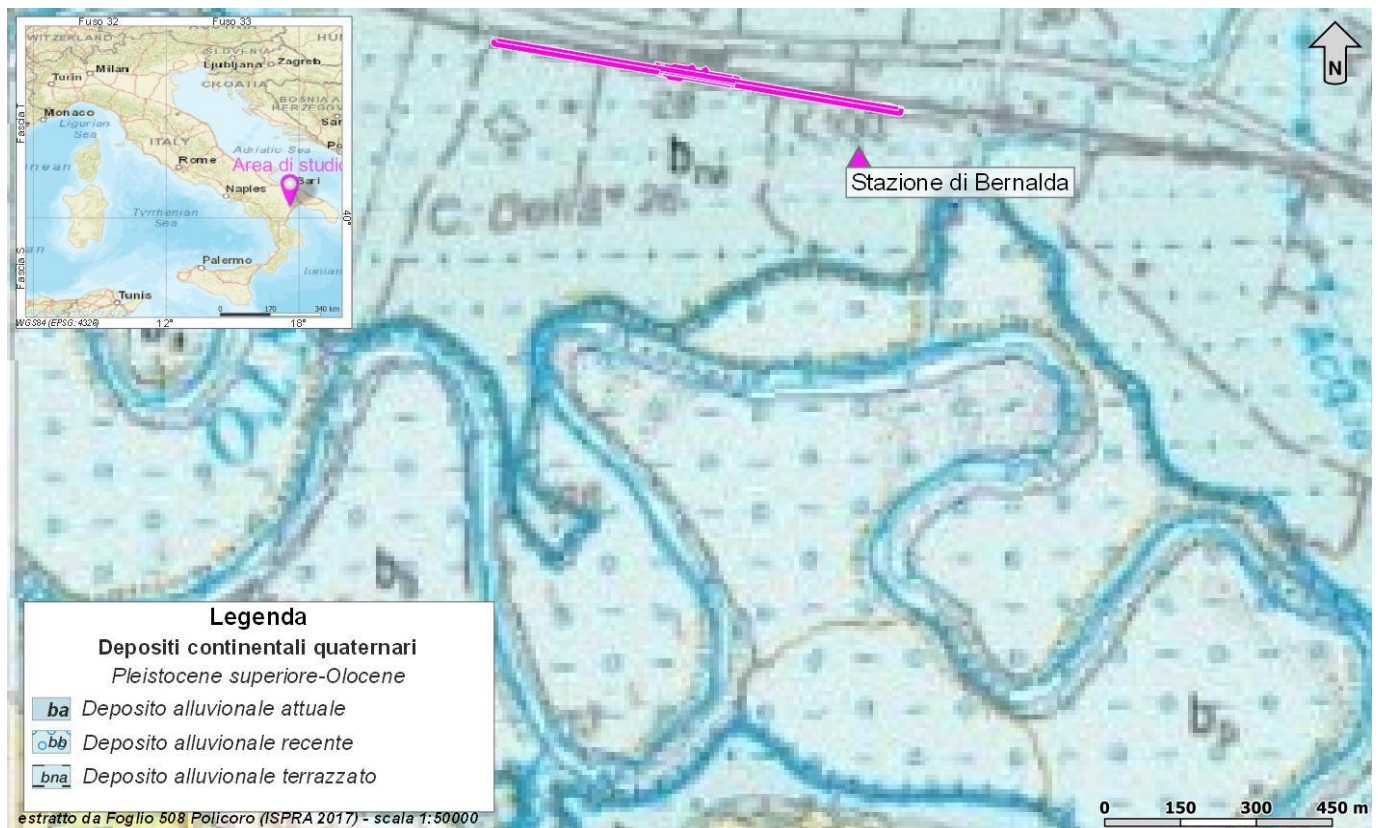
Figura 9 – Stralcio della carta geologica d'Italia 1:50.000 (riprodotta in scala 1: 15.000, foglio 508 Policoro) (da ISPRA 2016), con individuazione della tratta ferroviaria in esame (magenta).
