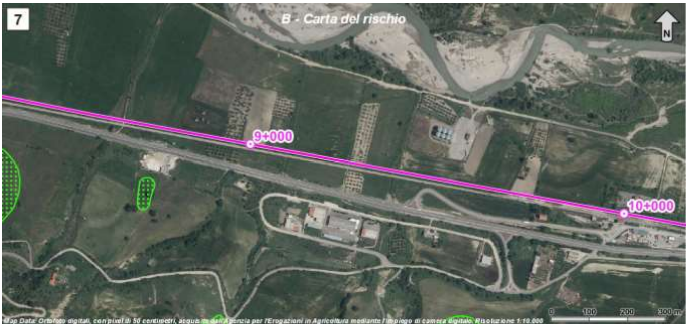
Figura 35 - Stralcio della tavola B "Carta del Rischio" del Piano Stralcio di Assetto Idrogeologico della Regione Basilicata (PAI 2017 – Autorità di Bacino distrettuale dell'Appennino Meridionale), con individuazione del tracciato ferroviario in progetto (linea magenta).
