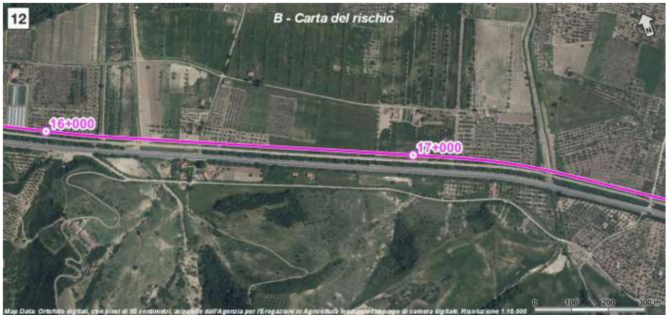
Figura 40 - Stralcio della tavola B "Carta del Rischio" del Piano Stralcio di Assetto Idrogeologico della Regione Basilicata (PAI 2017 – Autorità di Bacino distrettuale dell'Appennino Meridionale), con individuazione del tracciato ferroviario in progetto (linea magenta).
