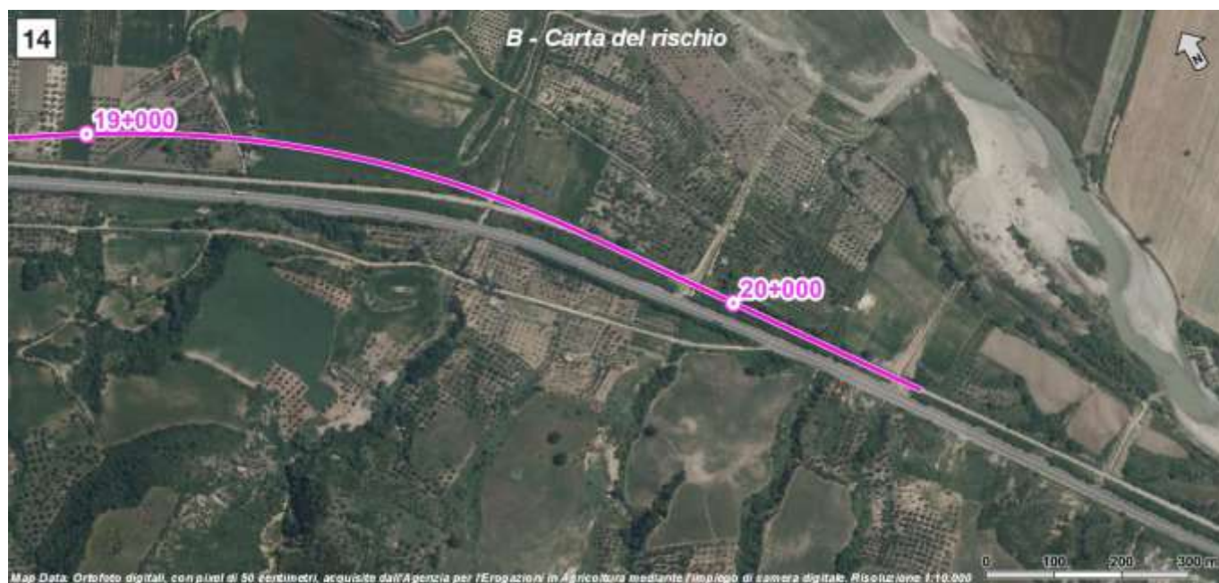
Figura 42 - Stralcio della tavola B "Carta del Rischio" del Piano Stralcio di Assetto Idrogeologico della Regione Basilicata (PAI 2017 – Autorità di Bacino distrettuale dell'Appennino Meridionale), con individuazione del tracciato ferroviario in progetto (linea magenta).
