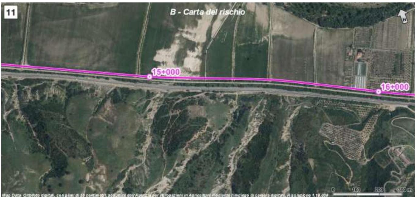
Figura 39 - Stralcio della tavola B "Carta del Rischio" del Piano Stralcio di Assetto Idrogeologico della Regione Basilicata (PAI 2017 – Autorità di Bacino distrettuale dell'Appennino Meridionale), con individuazione del tracciato ferroviario in progetto (linea magenta).
