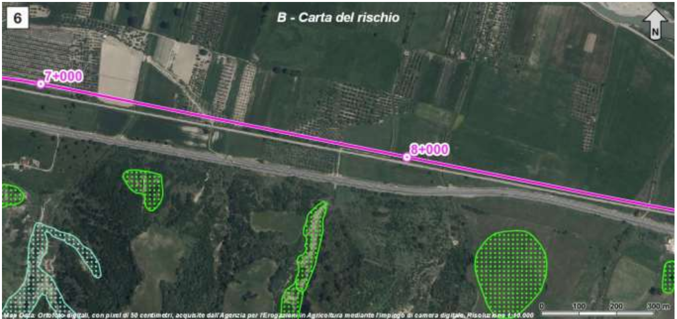
Figura 34 - Stralcio della tavola B "Carta del Rischio" del Piano Stralcio di Assetto Idrogeologico della Regione Basilicata (PAI 2017 – Autorità di Bacino distrettuale dell'Appennino Meridionale), con individuazione del tracciato ferroviario in progetto (linea magenta).
