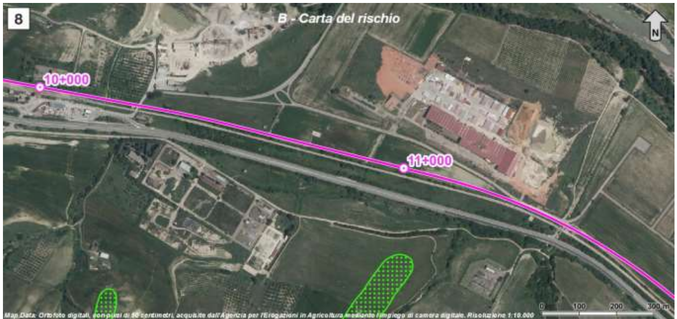
Figura 36 - Stralcio della tavola B "Carta del Rischio" del Piano Stralcio di Assetto Idrogeologico della Regione Basilicata (PAI 2017 – Autorità di Bacino distrettuale dell'Appennino Meridionale), con individuazione del tracciato ferroviario in progetto (linea magenta).
