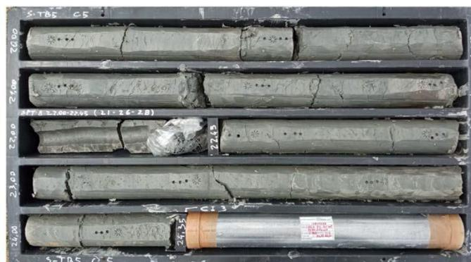
Le principali caratteristiche delle unità geotecniche intercettate, si presentano praticamente omogenee (nell'ambito della normale variabilità geotecnica) lungo tutto lo sviluppo del tracciato.
