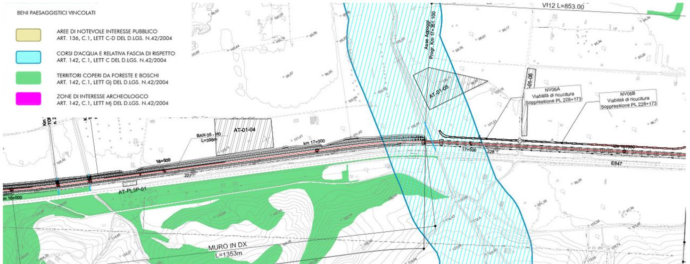
*Figura 21 - Interferenza del tracciato in progetto e del cantiere AT-01-05 tra le progressive 17+218 e 17+540 con la fascia di rispetto del Fosso la noce e la relativa fascia di rispetto.*
