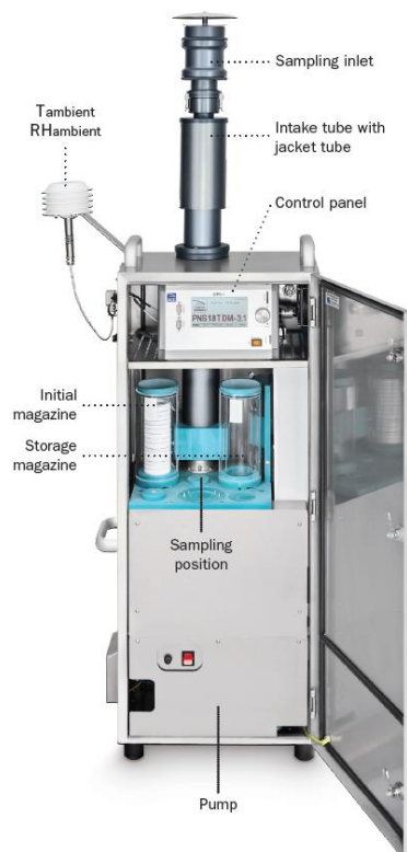
FIGURA 7 CAMPIONATORE SEQUENZIALE AUTOMATICO.
