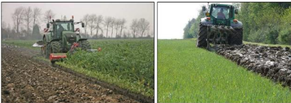
Esempio di pratica del sovescio in pieno campo. Si noti, nell'immagine a sinistra, l'impiego di una trincia frontale montata sulla stessa trattoria per alleggerire il carico sull'aratro portato
