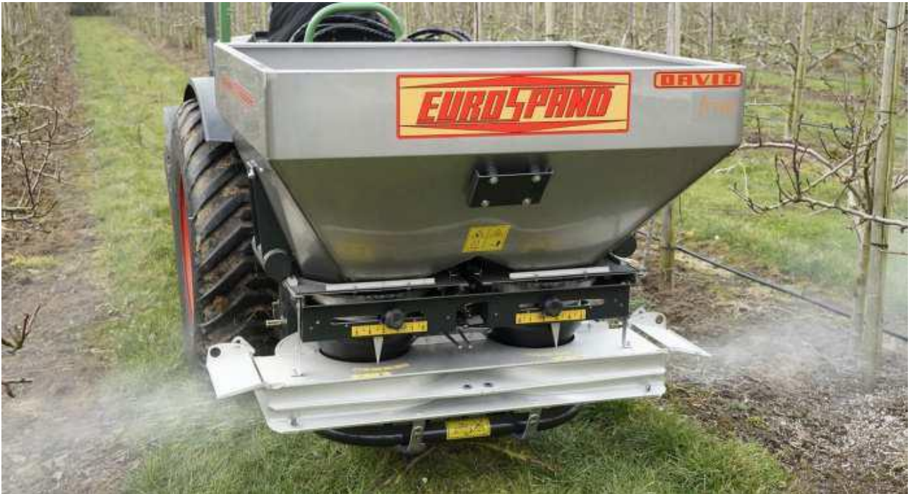
esempio di spandiconcime localizzato mono/bilaterale per frutteti
