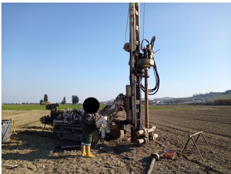
FIG.4: Fasi esecutive di una prova SPT.
