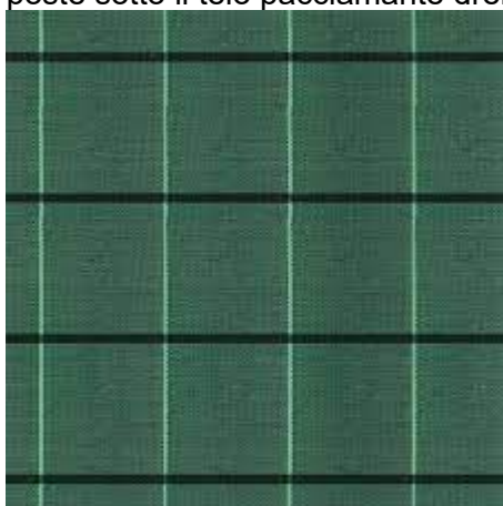
Esempio di telo pacciamante drenante in polipropilene 110gr/m 2
