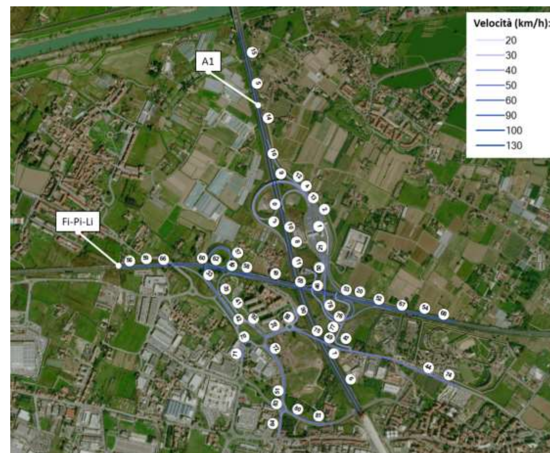
Figura 4-44: Rete di riferimento per l’analisi emissiva dello stato attuale e velocità di percorrenza
