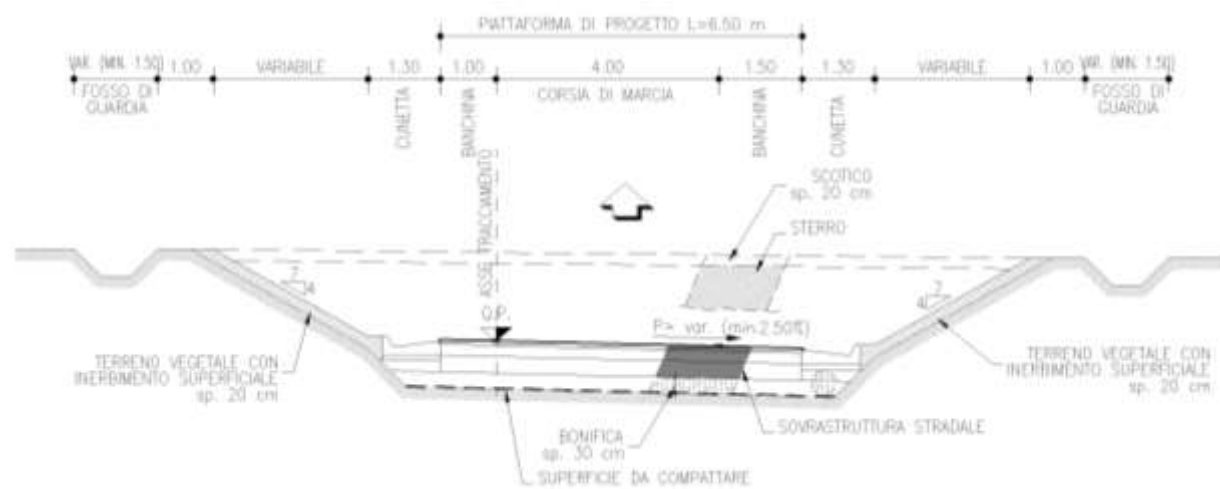
Fig. 3.3.3.2 - Sezione tipo monodirezionale in trincea
