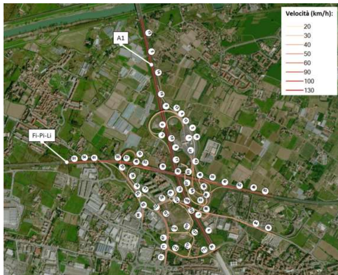
Figura 5-7: Rete di riferimento per l'analisi emissiva dello stato di progetto e velocità di percorrenza
