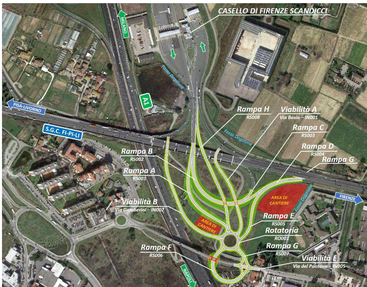
Figura 2-2 - Planimetria di inquadratura del progetto del nuovo nodo
