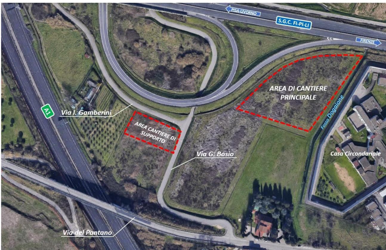
I lavori di accantieramento comprendono la realizzazione della recinzione dell'intera area mediante rete fissata a paletti, la preparazione delle aree logistiche, su cui avviene l'installazione dei box prefabbricati per uffici, servizi, ecc. o baracche di cantiere, e la realizzazione di eventuali allacci alle reti elettriche o idriche esistenti.
