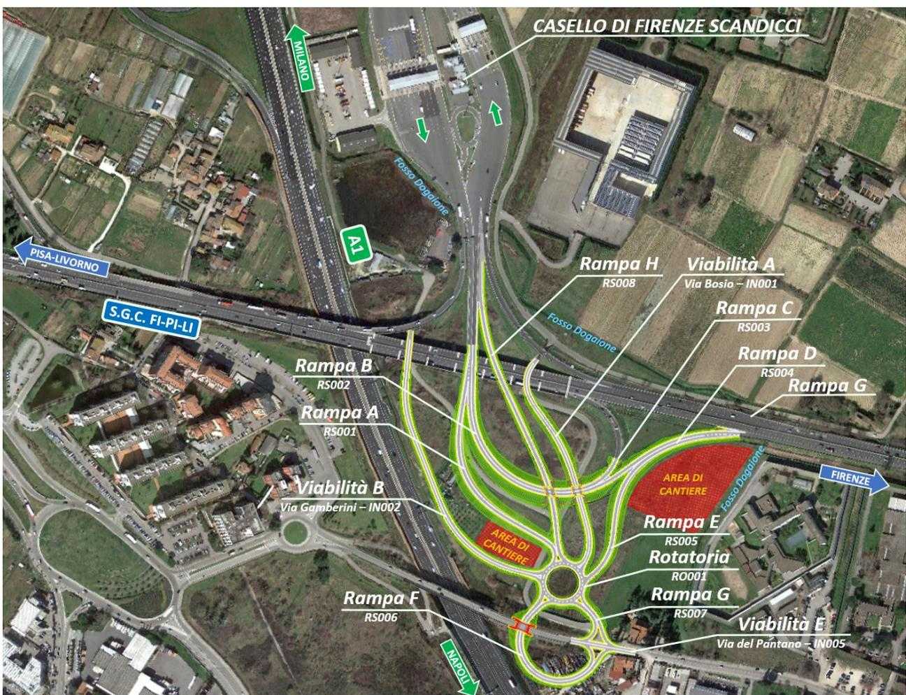
Fig. 3.1.1 - Planimetria di inquadramento del progetto del nuovo nodo
