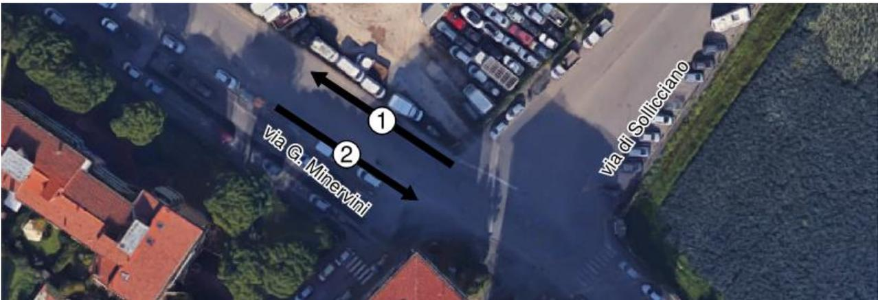
Figura 3-14. Indicazione manovre nodo B 'Intersezione Minervini-Sollicciano
