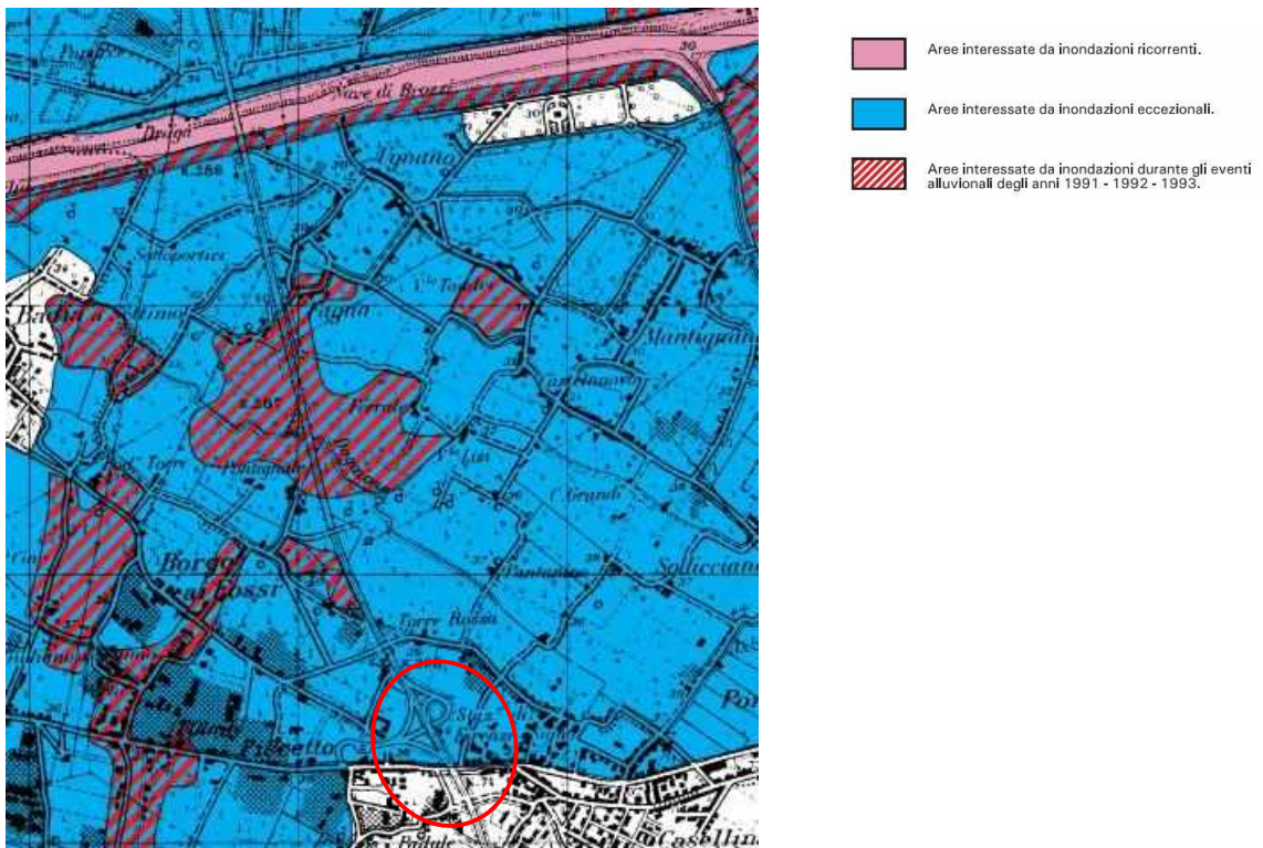
Figura 7-2 – Carta guida delle aree allagate da A.d.B. Arno, Stralcio 52 - In rosso l'area interessata dal progetto.
