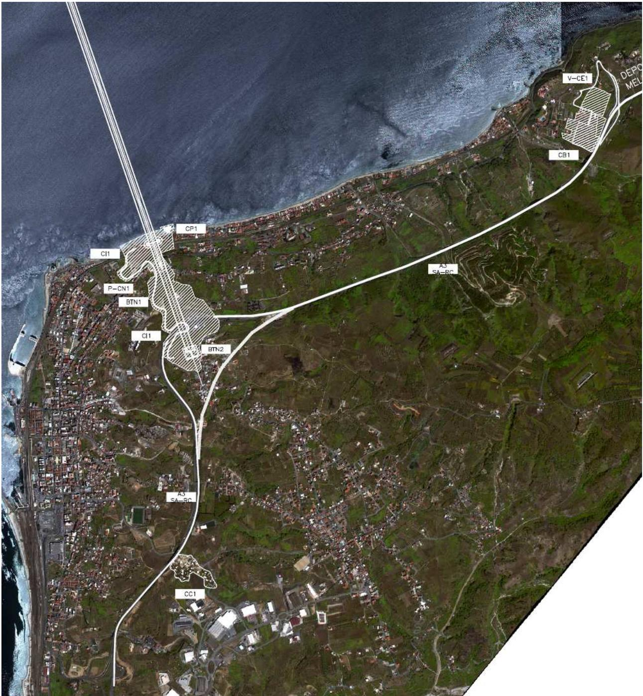
**Figura 4.4 Il sistema della cantierizzazione per il versante Calabria su foto aerea**
