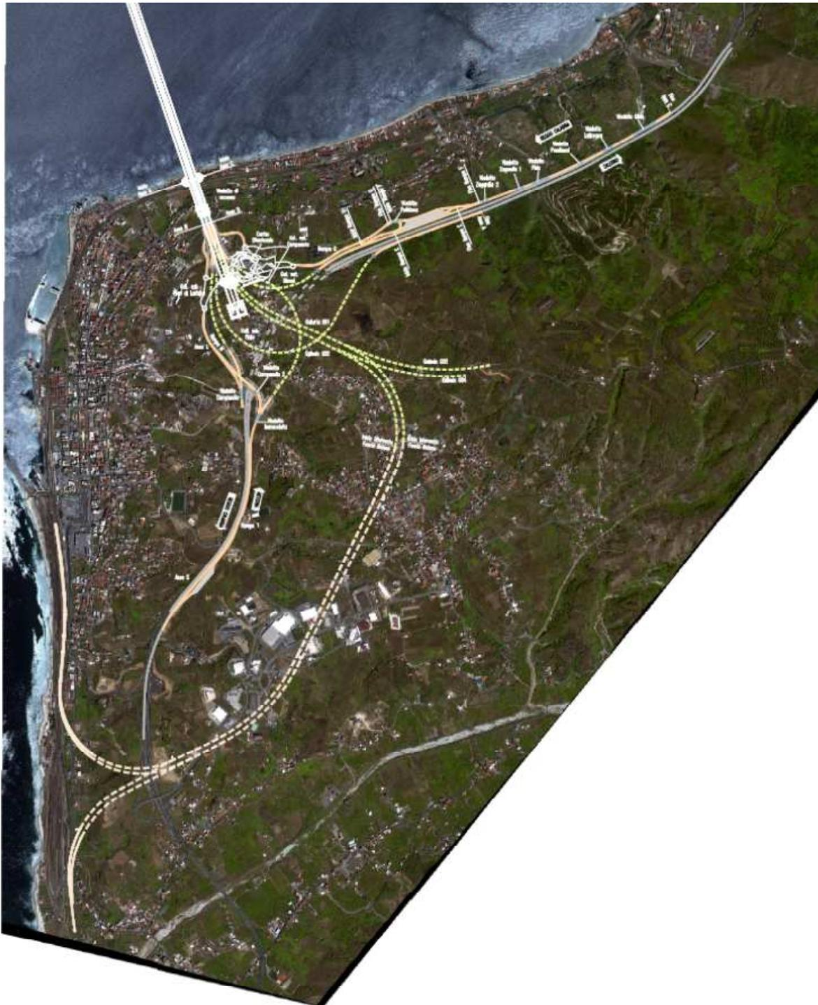
**Figura 4.3 Il sistema di progetto per il versante Calabria su foto aerea**
