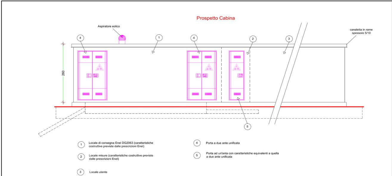
**Figura : Prospetto Cabina MT e veduta fotoinserimento Cabina MT di progetto**
